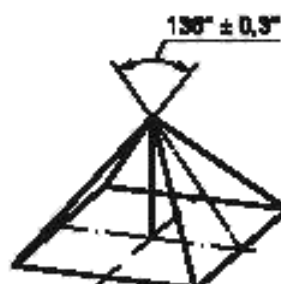
Рисунок 2 — Угол алмазной пирамиды Виккерса
