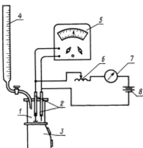
Установка для титриметрического определения алюминия с амперометрической индикацией конца титрования (см. чертеж).
