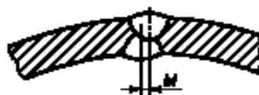
Рисунок 2 — Возможные отклонения размеров сварных швов
