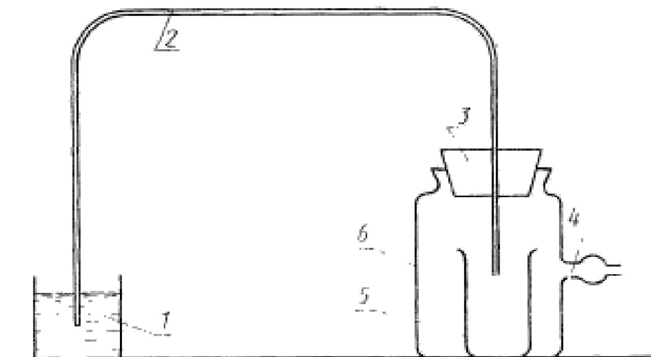
Другой конец трубки опускают в стакан 1 с растворителем.
